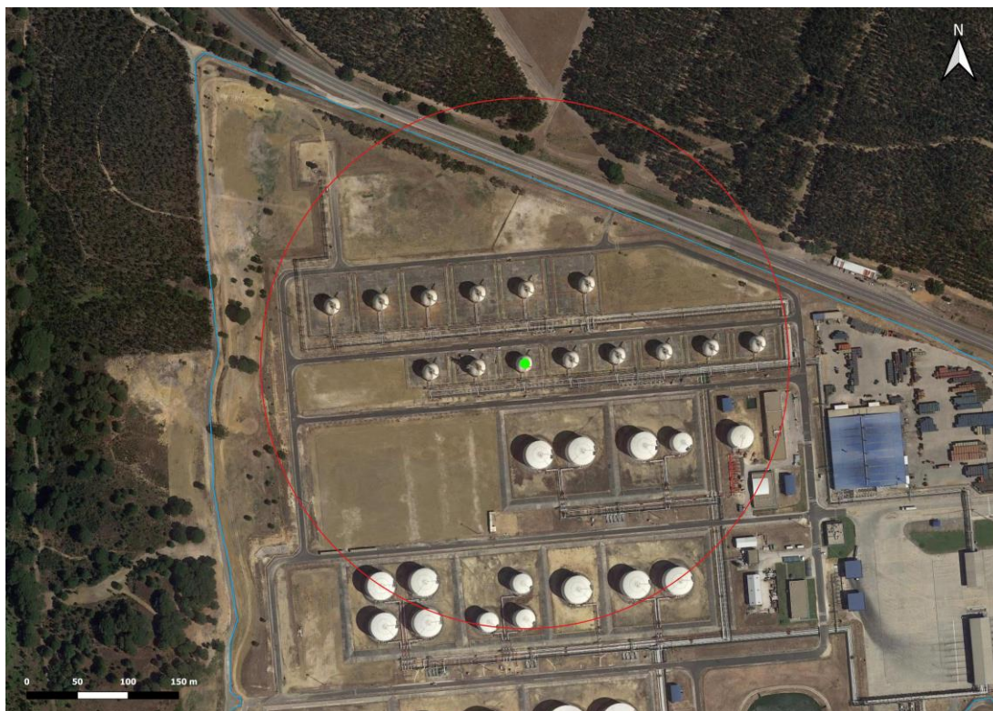
Figura 2 – Alcances dos fragmentos resultantes da rotura catastrófica de esfera de propano.
